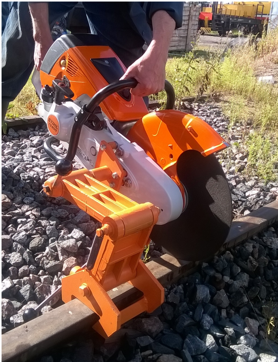
Рис. 2 Рис.1. Станок рельсорезный PP-800 (резка рельса).
